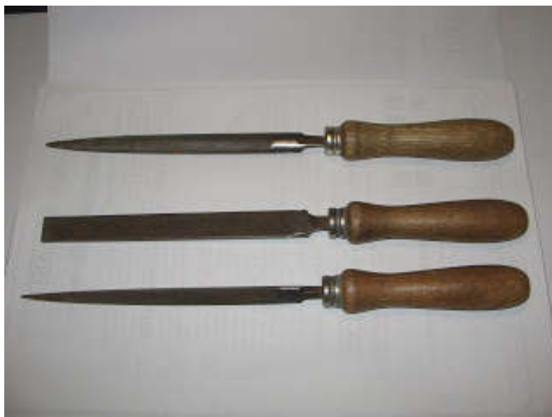
Figura 3 - Altri tipi di lime, leggermente più grandi dei tipi precedenti, utili per lavorazioni più grossolane.
