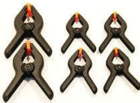
Figura 5 - Morsetti di differenti misure, utili per tenere fermi certi pezzi durante l'incollaggio.
