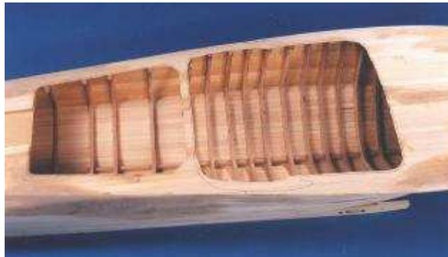
Importante è fare attenzione al senso della giusta venatura del legno rispettando scrupolosamente quella vera. Tutte le particolari parti in legno (falchette - bottacci ecc..) vanno fatti in un solo pezzo, se si dovessero rompere durante la lavorazione, vanno completamente ricostruiti dato che non devono avere né incollature né stuccature.
